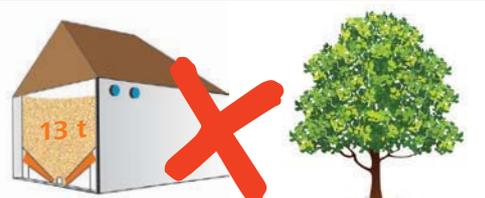
FALSCH: Einblas- und Absaugstutzen führen zwar mit zwei belüftenden Verschlussdeckeln ins Freie, aber das Fassungsvermögen des Lagers ist > 10 t. Es ist ein Gesamtlüftungsquerschnitt von mind. 4 cm<sup>2</sup>/t notwendig, ein Deckel hat 20 cm<sup>2</sup> Querschnitt. Belüftung über die Deckel ist bis zu einem Fassungsvermögen von 40 t möglich.
