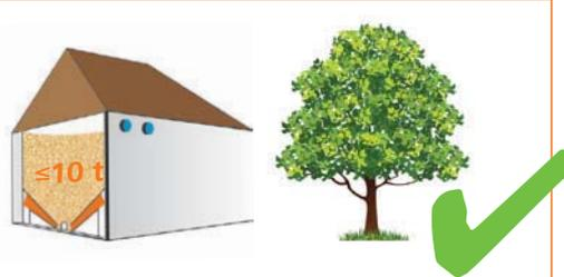
RICHTIG: Einblas- und Absaugstutzen führen ins Freie. Auf beiden ist ein belüftender Verschlussdeckel angebracht. Die fest installierten Leitungen nach draußen sind nicht länger als 2 Meter.
