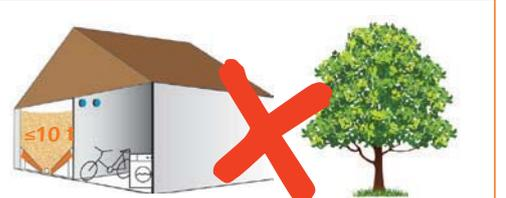
FALSCH: Auf beiden Stützen ist zwar ein belüftender Deckel angebracht. Einblas- und Absaugstutzen führen aber nicht ins Freie oder in einen ausreichend belüfteten Aufstellraum der Heizung mit Verbrennungsluftöffnung, sondern in einen Nebenraum. In dieser Situation dürfen nur geschlossene Deckel angebracht werden! Die Belüftungsöffnung nach draußen muss über eine separate Öffnung geschaffen werden.
