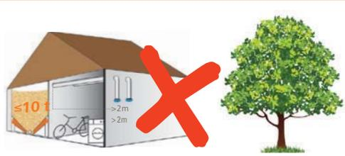
FALSCH: Einblas- und Absaugstutzen führen ins Freie. Auf beiden ist ein belüftender Deckel angebracht. Allerdings sind die Leitungen zwischen Lager und Kupplung länger als 2 Meter. Dadurch ist die Belüftung nur eingeschränkt wirksam. Es sollten separate Lüftungsöffnungen geschaffen werden.
