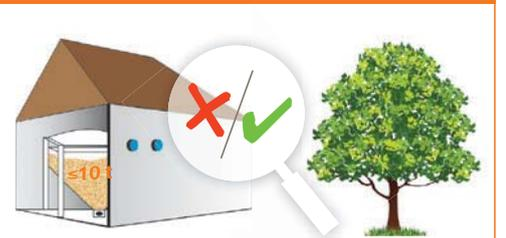
FALSCH/RICHTIG: Bei Sacksilos, die direkt im belüfteten Aufstellraum der Heizung montiert sind, werden KEINE belüftenden Deckel benötigt! Wenn die Sacksilos in einem separaten Raum aufgestellt sind, sollten diese nach außen belüftet werden, z. B. über mind. zwei belüftende Deckel.
