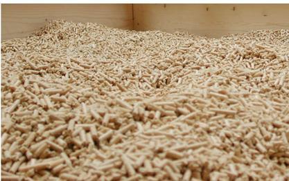
Damit die Pelletsheizung von Paradigma lange und zuverlässig läuft, kommt es auf die sichere sowie trockene Lagerung und den schonenden Transport des Brennstoffs an. Ein Pelletlager benötigt nur wenig Platz, oft reichen 4 bis 6 m<sup>2</sup> aus.
